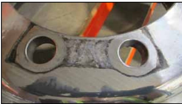
Corrosión galvánica en las superficies de contacto de la cubierta o del anillo de protección de las tuercas de la llanta
