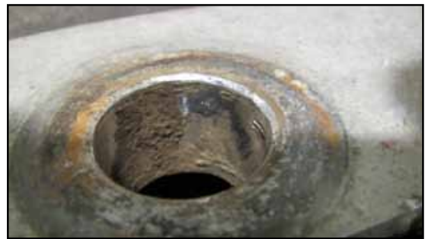
Área de las tuercas de la llanta con corrosión galvánica
